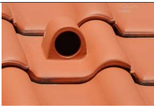
Nestpan, niet succesvol en vaak gevaarlijk. Deze nestpannen hebben een te grote opening en het wordt te heet. Dit zijn vaak luchtpannen met uitgezaagd rooster; fout dus.
